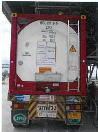
ภาพที่ 2.2-11 (ต่อ) รถขนส่งกากของเสียที่ติดตั้งระบบ GPS และติดเบอร์โทรศัพท์ และการติดป้ายความเป็นอันตราย พร้อมอุปกรณ์ระงับเหตุ
